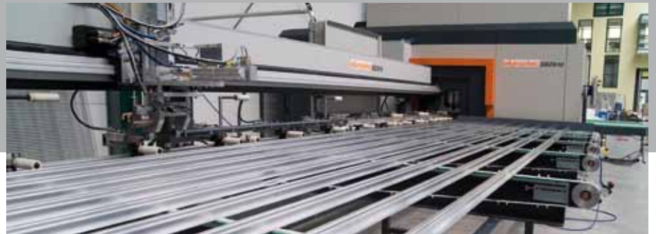
Vollautomatisches Sägen am Elumatec SBZ610
