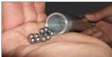
Einschlagstößel aus dem Halter ziehen und maximal 12 Kugeln einfüllen.
