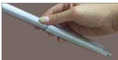
Schlagstößel vorsichtig einführen und das Werkzeug ist einsatzbereit. Bei zu starkem Druck werden die Kugeln unten herausgedrückt. Vorsichtig handhaben!
