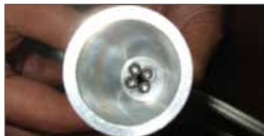
Kontrollieren dass alle Kugeln in die kleine Bohrung gerollt sind. Evtl. leicht schütteln.
