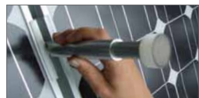
Die Kugel mit einem Kunststoffhammer einschlagen. Der Kopf des Einschlagstößels ist aus Alu und nicht für das Arbeiten mit einem Stahlhammer geeignet.
