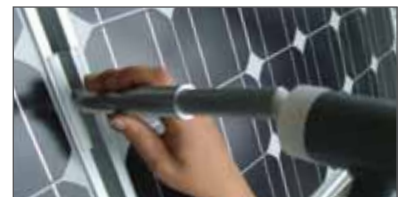
Golpear la bola con un martillo de plástico . El cabezal de la varilla de empuje es de aluminio. Por eso mismo, le aconsejamos que no utilice un martillo de acero.
