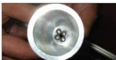
Zkontrolovat zda-li všechny kuličky zapadly do malého otvoru. Eventuálně lehce sklepat.
