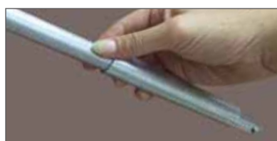
Tlukadlo opatrně zavést a nástroj je připraven k použití. Při velmi silném tlaku se kuličky ze spodu vytlačí. Manipulovat opatrně!
