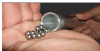
Tlukadlo z držáku vytáhnout a naplnit maximálně 12 kuličkami.
