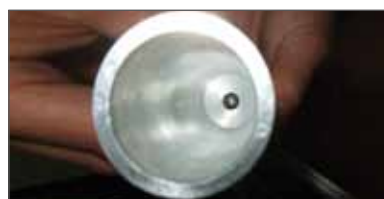
Jsou-li všechny kuličky zapuštěny, může být nasazeno tlukadlo.
